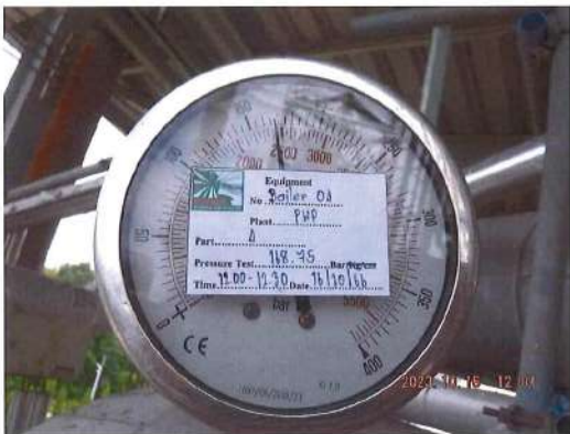
ภาพถ่ายแสดงแรงดันขณะทำการทดสอบแรงดันในการตรวจสอบหม้อน้ำ
